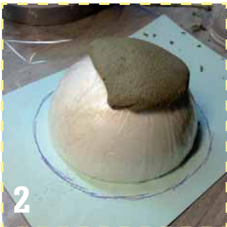
Bekleed de bol met het kneedbare beton
